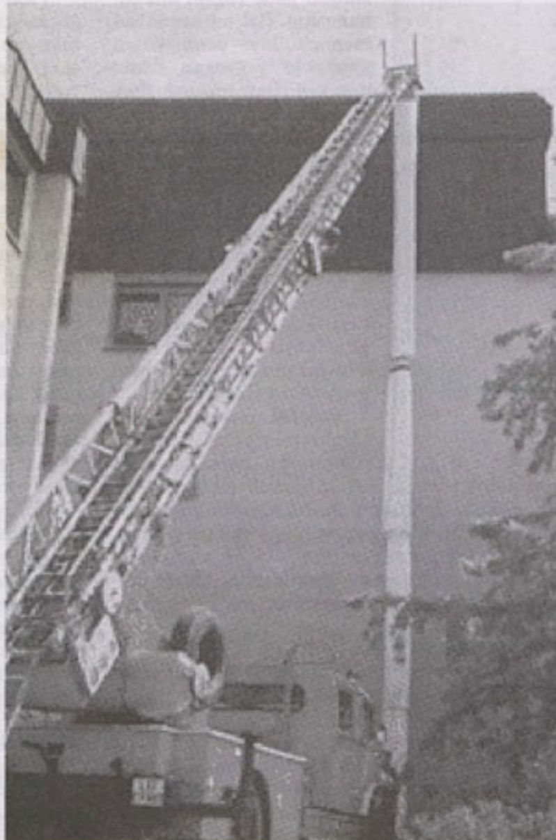
Movable chute : biasa digunakan oleh pemadam kebakaran untuk secara cepat menurunkan orang yang tidak mungkin turun melalui tangga.
